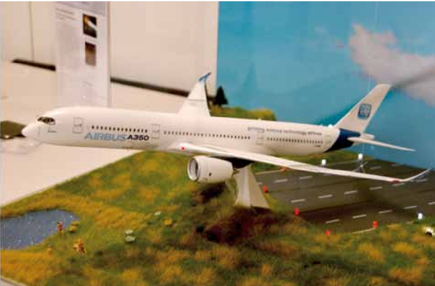
Flugzeugmodell mit geprägten Dehnungsmessstreifen
