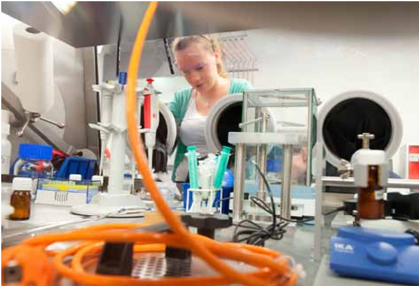
Die Forscher in STORE-E arbeiten in Handschuhboxen, die mit dem Inertgas Argon gefüllt sind, an den Grundlagen der Batterietechnologien von morgen.
