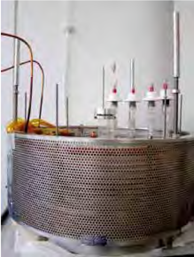
RIT-35 Großtriebwerk mit fünf Durchführungen für die Messungen der Ionenoptik, bestückt mit drei Langmuir-Sonden und zwei Fenstern für die optische Emissionsspektroskopie.
