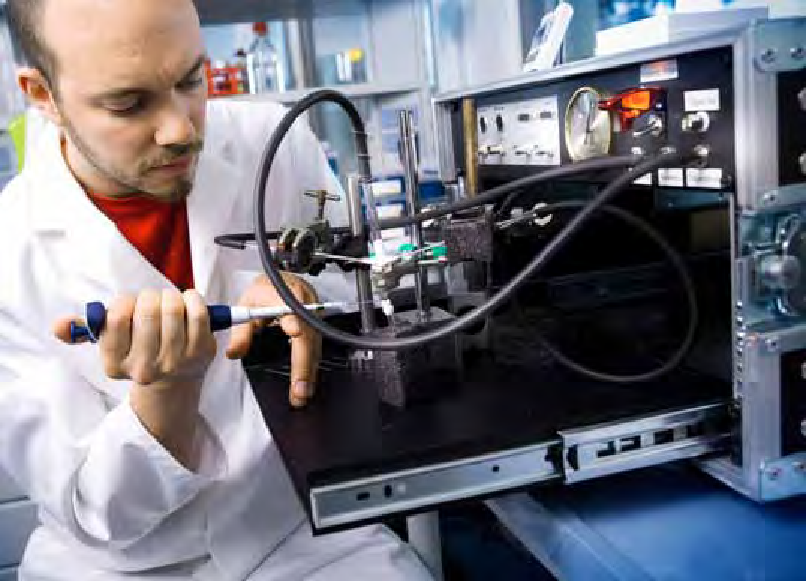
Elektroantennografie: Entwicklung eines hochsensitiven Gerätes auf der Basis von Insektenantennen, das zum Nachweis flüchtiger Substanzen wie zum Beispiel Sprengstoff und Drogen genutzt werden kann. © Hessen schafft Wissen
