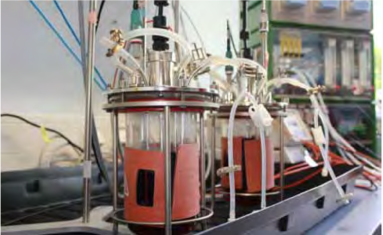
Bioreaktoren mit Sonden und Steuerungseinheit
