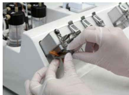
LOEWE-Schwerpunkt iCANx: Wissenschaftlerin bestückt ein weitgehend automatisiertes Färbe- gerät zur räumlichen Analyse von Geweben. © Nadja Ritschel
